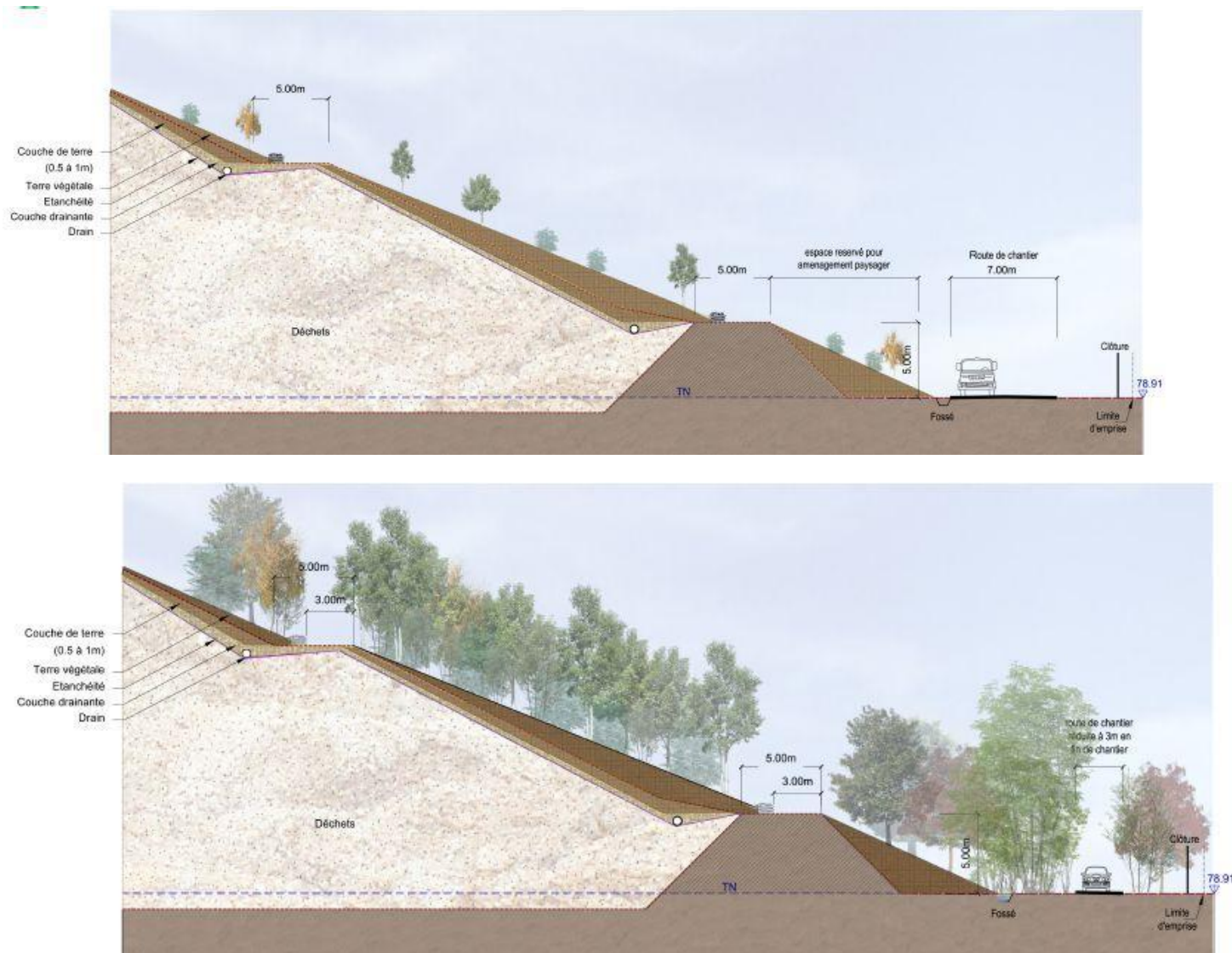
Figure 20 : Coupes de principe du dôme de l'ISDND en entrée de site - pendant et après exploitation
